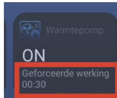
Quand une surproduction suffisante est enregistrée, le système indiquera une « opération forcée ». Mais la pompe à chaleur allait de toute façon s'efforcer d'atteindre sa température physiquement réglée. Par conséquent, il n'y a pas de différence entre avec et sans SmartEnergy dans le réglage manuel.
