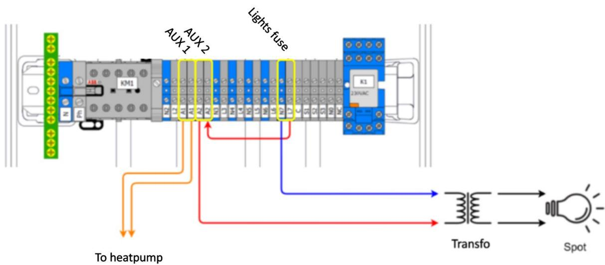
**RACCORDS DE POMPE DE CIRCULATION pour vitesse variable (sur les bornes montées sur rail au bas de l'armoire)**
