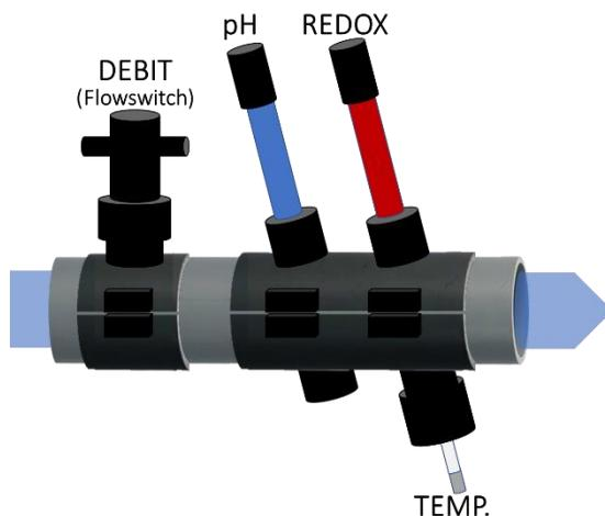
7. Fixer le boîtier POOL GUARD sur un mur. Raccordez son alimentation et raccorder les sondes et le contrôleur de débit comme suit :
